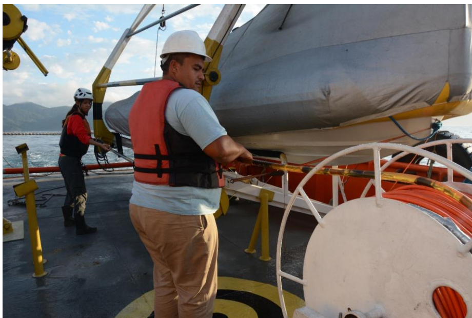
Figura II.3-1: Lançamento do arranjo de hidrofones a partir do guincho hidráulico. O cabo laranja enrolado no guincho é o cabo de reboque. Nesta foto, o arranjo de hidrofones (tubo preenchido a óleo) está sendo manuseado para lançamento a partir da popa da embarcação.
