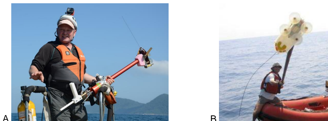
Figura II.5-2: Transmissor do tipo DTAG utilizados durante as Campanhas de Telemetria do PMC-BS: (A) sistema de fixação com rifle ARTS; e (B) sistema de colocação com vara de fibra de carbono. Notar o quatro copos de sucção (ventosas) de fixação na doto (B).
