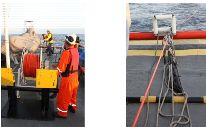
Figura 2: Cabo do MAP sendo lançado na água (esquerda) e detalhe mostrando as cordas com os mosquetões presos no chinese finger (direita). Note que o cabo passa pelo rolete na popa da embarcação antes de ser lançado no mar.
